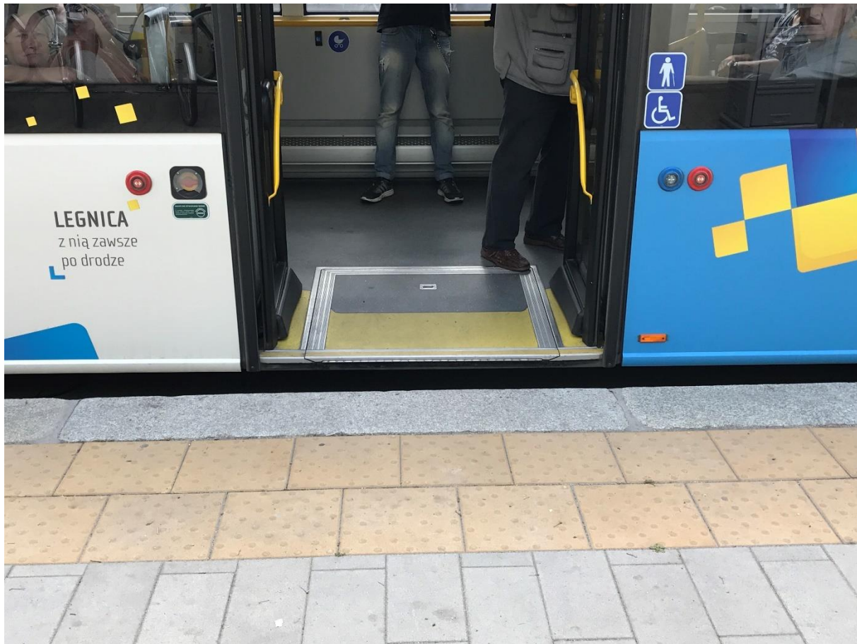
Rys. 7.3 Zminimalizowana przerwa między peronem przystankowym a autobusem
